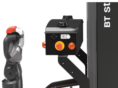
Nødstoppknapper som er lett tilgjengelig for operatørene på arbeidsplassen
